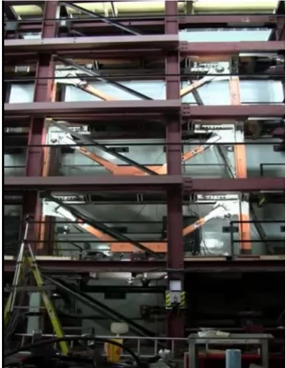
الشكل (21-2): تجربة (RTHS) المرجعية لبناء ثلاث طوابق مزودة بمخمدات (MR). (Friedman and Dyke 2012)
