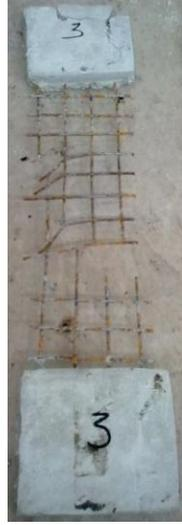
الشكل 6-8: شكل انهيار العينة رقم (3)
