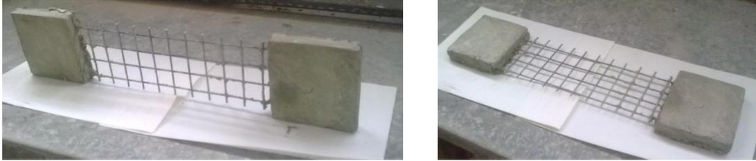
الشكل 4-8: عينات شبكات الأسلاك الملحومة المعدة للاختبار
