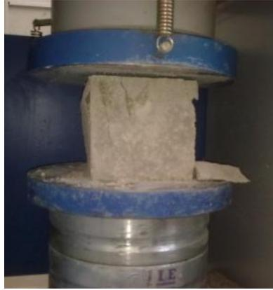
الشكل 7-2: شكل انهيار العينة المكعبية (10X10X10 cm)
