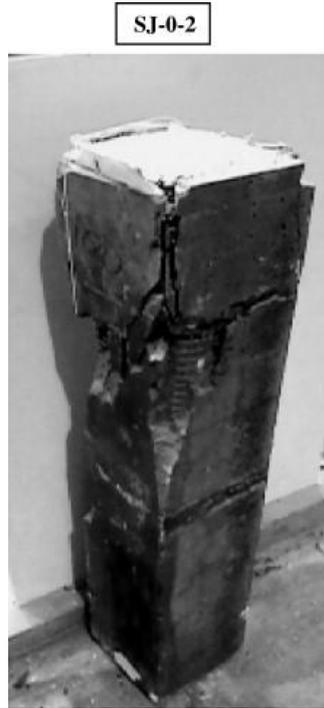
الشكل 10-2: شكل الإنهيار للعينات المقواة [1]
