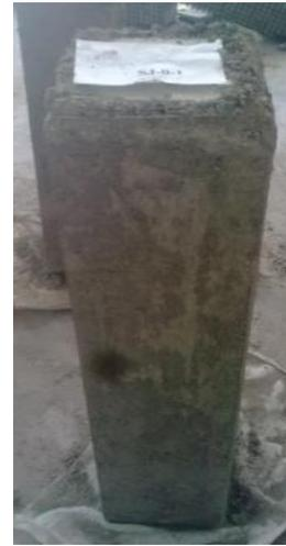
الشكل 10-3: العينة SJ-0-1 بعد تنفيذ طبقة التدعيم
