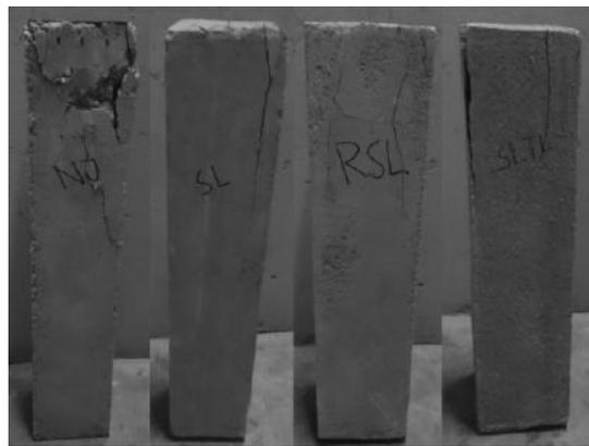
الشكل 2-19: أشكال انهيار العينات [7]
