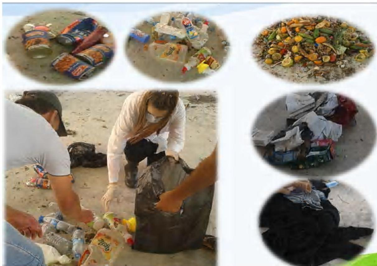
الصورة رقم (5): تجربة التركيب النوعي لعينة النفايات المأخوذة.
