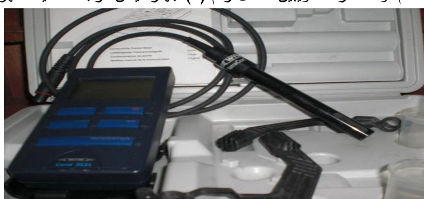
الشكل رقم (5): جهاز قياس درجة الناقلة الكهربائية.
