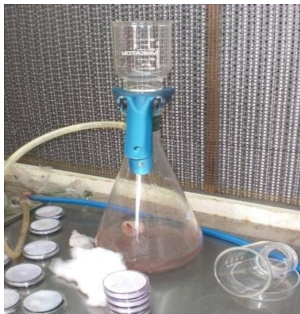
الشكل رقم (7) : جهاز ترشيح مزود بمخالية هوائية.
