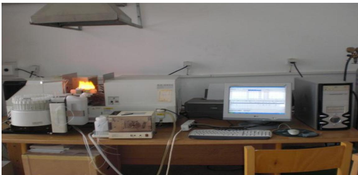
الشكل رقم (8): جهاز الامتصاص الذري باللَّهَب.
