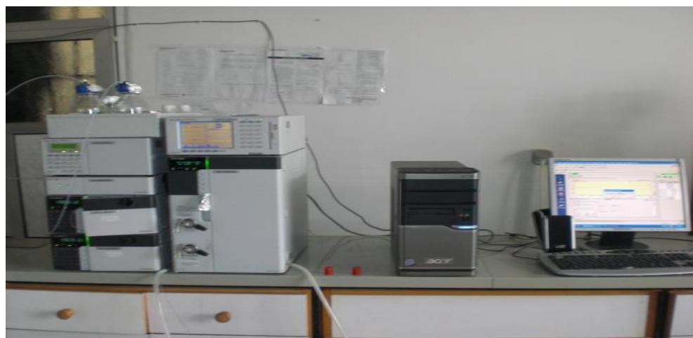
الشكل رقم (6): جهاز الكروماتوغرافيا الشاردية الـ (IC).
