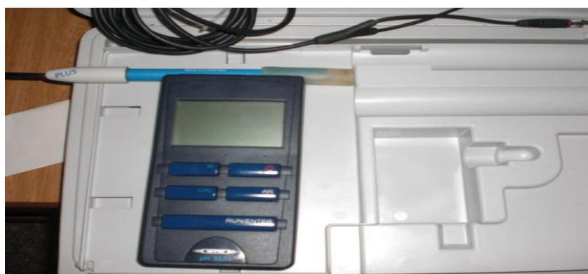
الشكل رقم (4) : جهاز قياس درجة الحموضة (PH).
