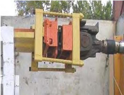
(ج) طريقة وصل المحرك الهيدروليكي مع النموذج المختبر
