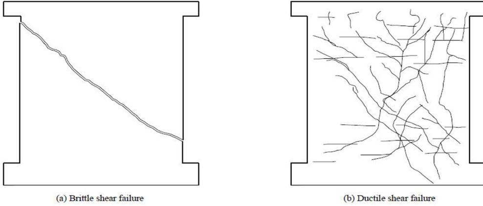
الشكل (6-2) : أنواع انهيار القص [14]
