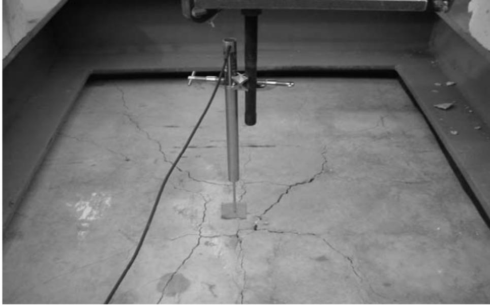
الشكل (18-2): خطوط الانكسار القطرية عند انهيار البلاطة غير المقواة (Limam et al;2003)
