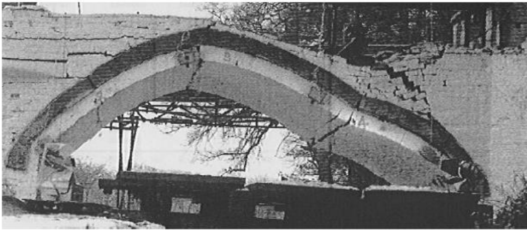
الشكل (٢-١٩): ميكانيكية انهيار جسر بريستود (Cavicchi and Gambarotta, 2005)
