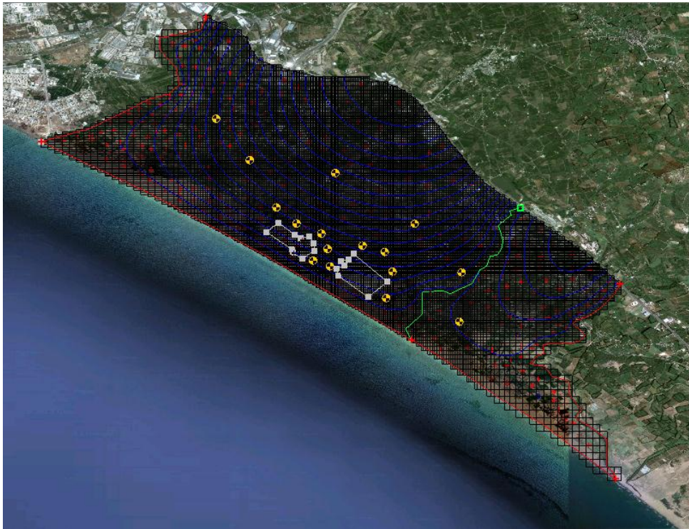
الشكل رقم (5-54): إظهار خطوط تساوي الضاغط Head Contours باللون الأزرق.
