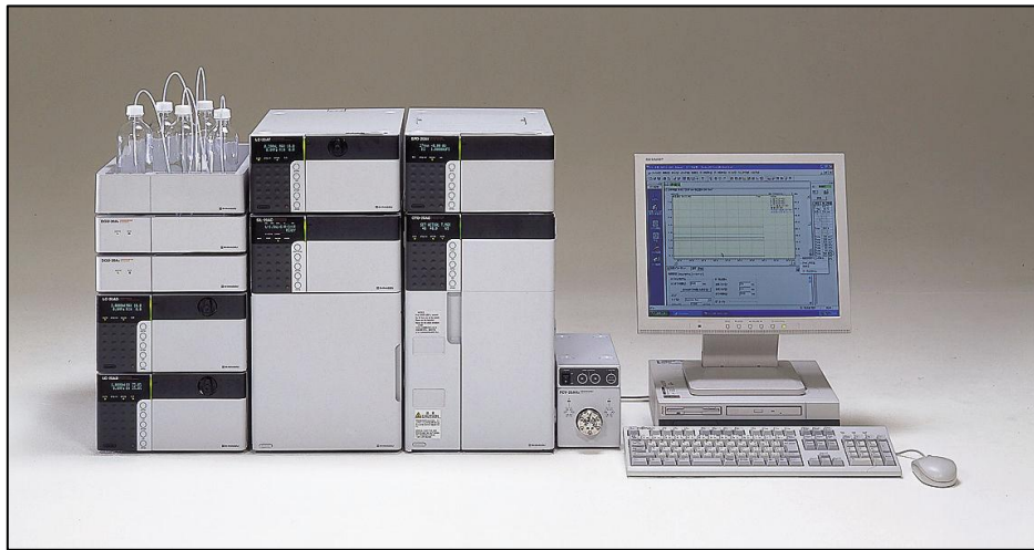
الشكل رقم (3-9): جهاز الكراماتوغرافيا الشاردية (IC).
