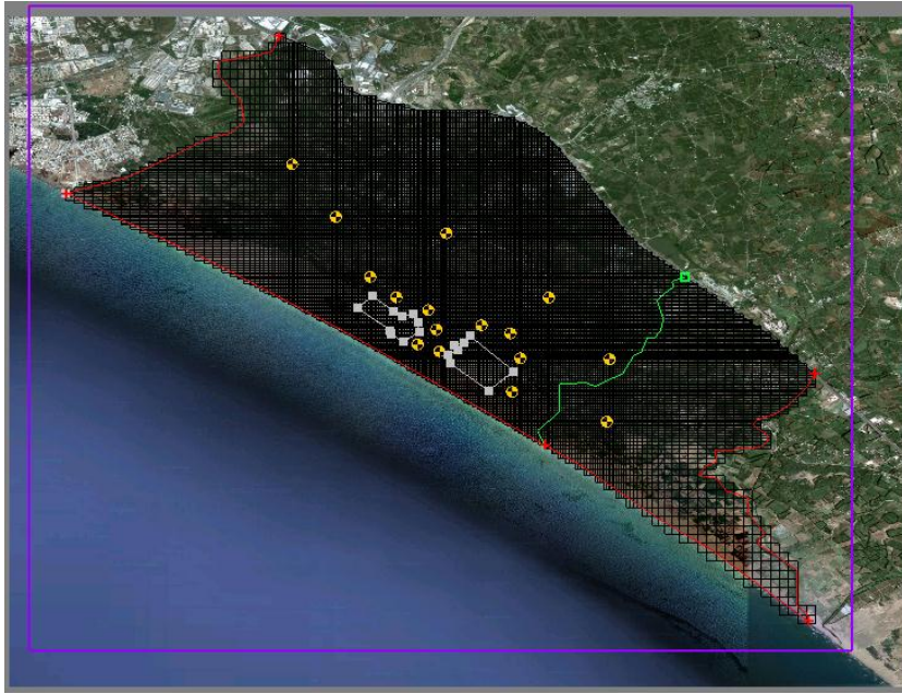
الشكل رقم (4-15): إنشاء شبكة الخلايا الفعالة وغير الفعالة.
