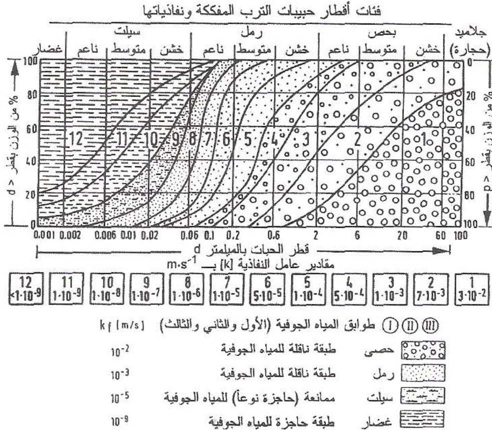
الشكل رقم (2-1): نفاذية التربة المفككة اعتماداً على التوزيع الحبيبي [8].
