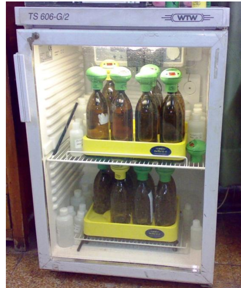
الشكل رقم (3-8): الحاضنة والزجاجات المستخدمة في قياس تركيز الـ BOD_5 .
