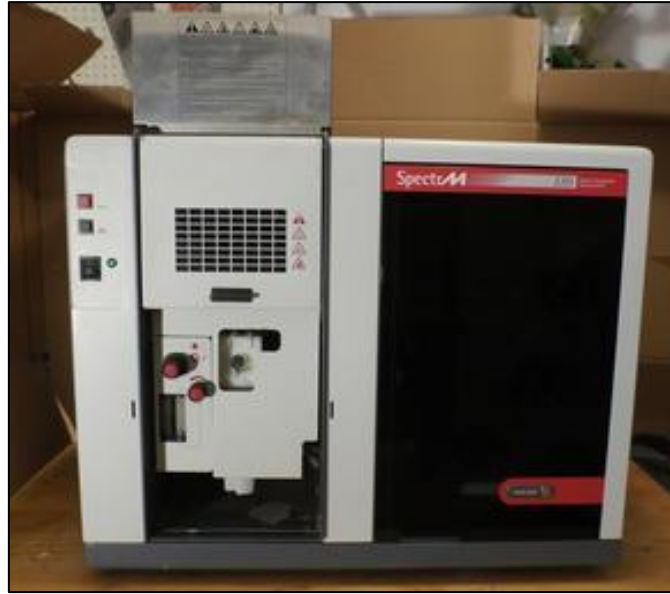
الشكل رقم (3-10): جهاز الامتصاص الذري.
