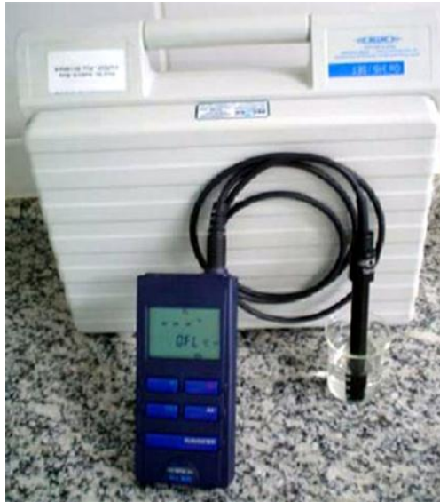
الشكل رقم (3-4): جهاز قياس درجة الحرارة ودرجة الحموضة pH.
