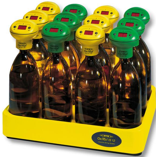
الشكل رقم (3-8): الحاضنة والزجاجات المستخدمة في قياس تركيز الـ BOD_5 .
