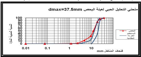
الشكل (2-15) منحنى التحليل الحبى لتحديد معامل انتظام عينة البحص الخامسة Dmax=37.5mm
