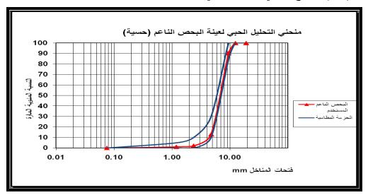
الشكل (9-2) منهني التحليل الحبي لعينة البحص الناعم. Dmax= 12.5mm
