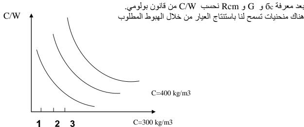
الشكل (2-18) منحنيات حساب العيار C/W بدلالة الهبوط و النسبة C/W.
