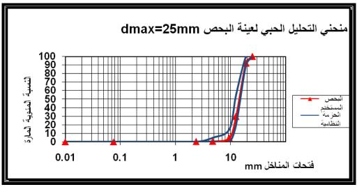
الشكل (7-2) منحنى التحليل الحبى لعينة البحص Dmax=25mm
