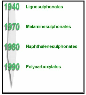
الشكل (1-1) تطور تقنية صناعة الملدنات عبر الزمن
