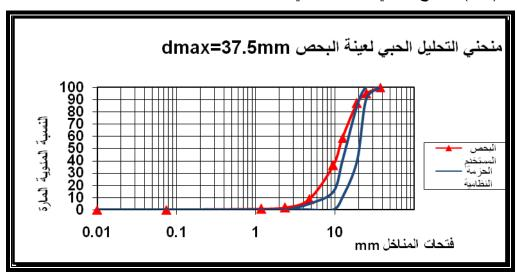
الشكل(2-6) منحني التحليل الحبي لعينة البحص Dmax=37.5mm
