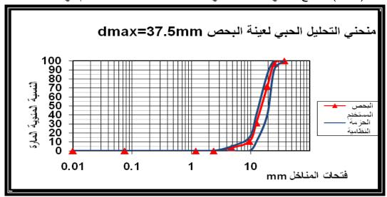
الشكل(2-14) منحنى التحليل الحبي لتحديد معامل انتظام عينة البحص الثالثة Dmax=37.5mm
