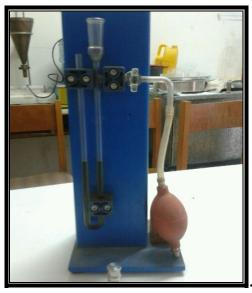
الشكل (2-2) جهاز بلين لقياس السطح النوعي للإسمنت.
