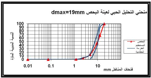
الشكل(2-8) منحنى التحليل الحبى لعينة البحص Dmax=19mm.
