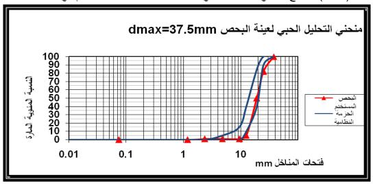
الشكل(2-21) منحنى التحليل الحبى لتحديد معامل انتظام عينة البحص الأولى Dmax=37.5mm
