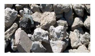
الشكل (1-13): شكل الحجارة الكبيرة قبل طحنها و بعد فصل الشوائب الأخرى.
