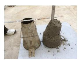
الشكل (2-11) قياس الهبوط بمخروط أبرامز
