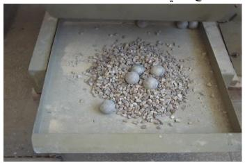
الشكل (2) الكرات الفولاذية في جهاز لوس انجلس
