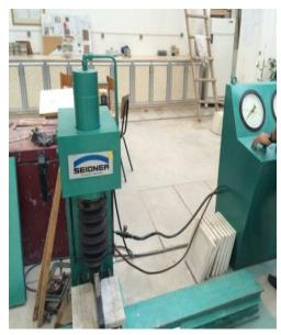
الشكل(11-3) آلية قياس المقاومة على الشد بالانعطاف لعينات بلاط الأرصفة الإسمنتي
