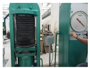
الشكل(3-13) آلية قياس المقاومة على الضغط البسيط لعينات الأنترلوك
