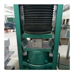
الشكل (10-3) آلية قياس المقاومة على الضغط البسيط لعينات البلوك المفرغ
