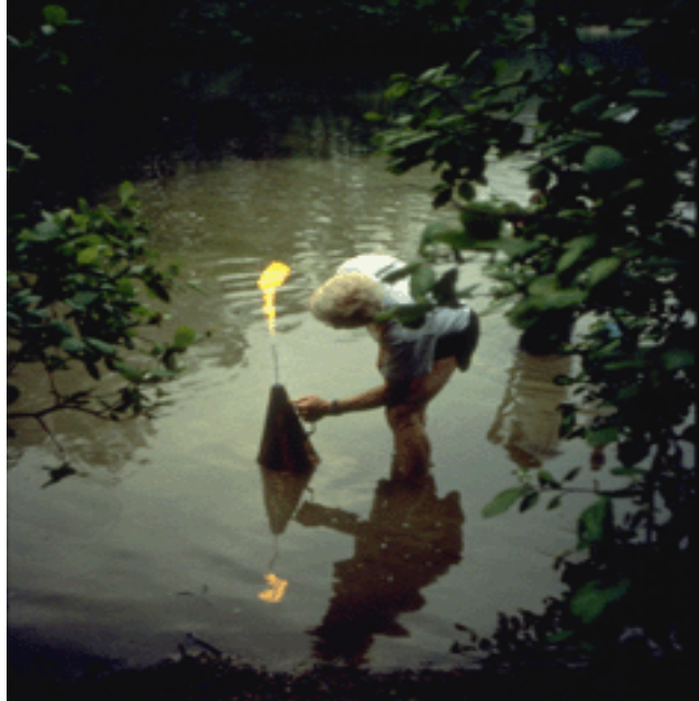
شكل (1-2) باحث يستخدم غاز المستنقعات مباشرة كمصدر طاقة.
