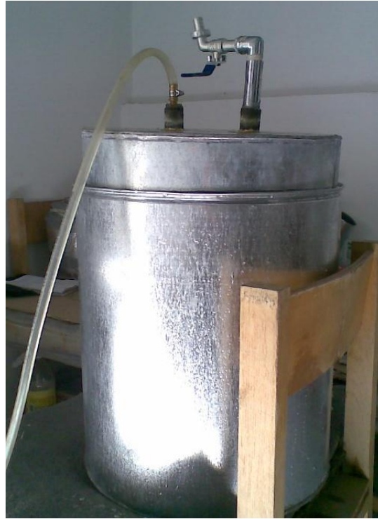
شكل(7-17) خزان تجميع الغاز
