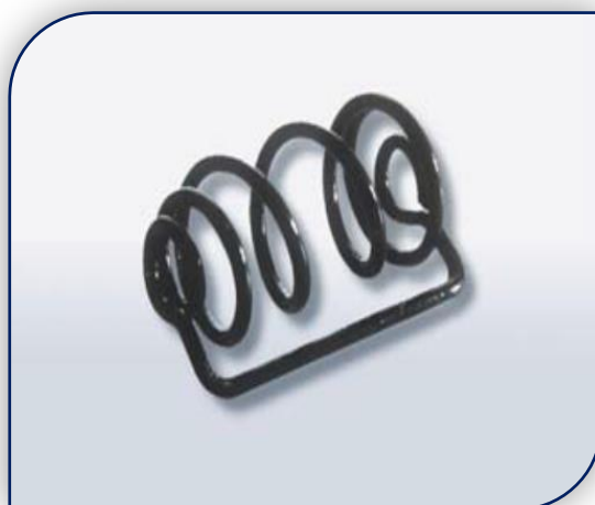
الشكل (22) يوضح السلك المعدني الدستوري المستخدم في فحص الذوبان (113)
