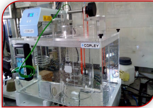
الشكل (21) يوضح جهاز التففت المستخدم لتحديد زمن تففت التحاميل
