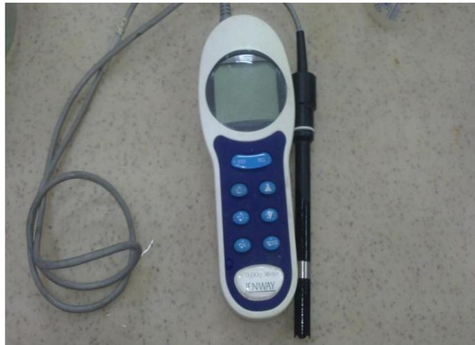
الشكل (٤-٥) جهاز قياس الأوكسجين المنحل
