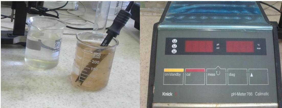
الشكل (أ-٣-٤) جهاز قياس ال PH الشكل (ب-٣-٤) المسبر
