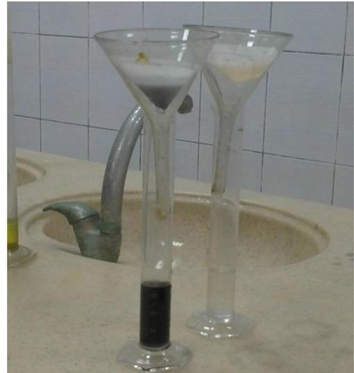
الشكل (٤-٦-أ) عملية ترشيح المياه باستخدام أوراق الترشيح والأقماع وأنابيب الاختبار
