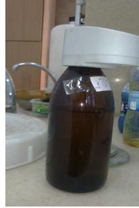
الشكل (أ-٤-٤) زجاجة تحوي على العينة الشكل (ب-٤-٤) جهاز قياس الـ BOD5
