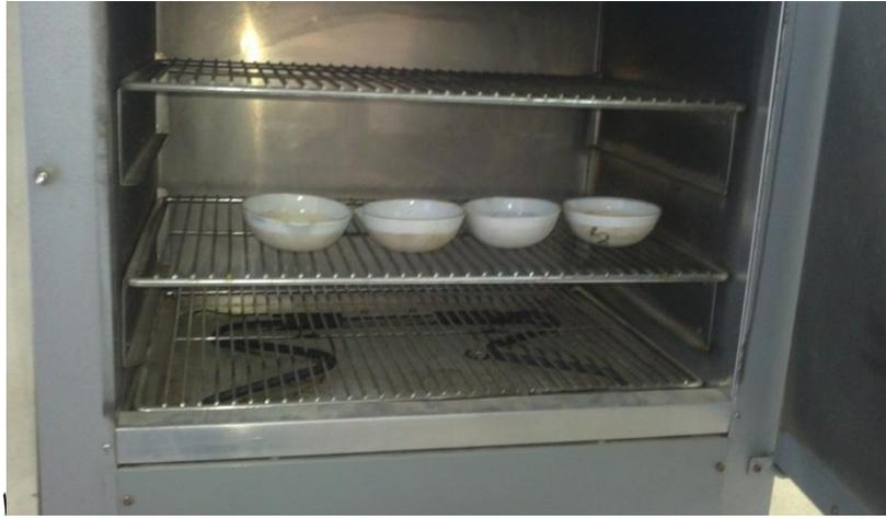
الشكل (٤-٦-ج) الفرن ذو درجة الحرارة (١٠٥) درجة مئوية مع الجفئات التي تحوي عينات المياه .
